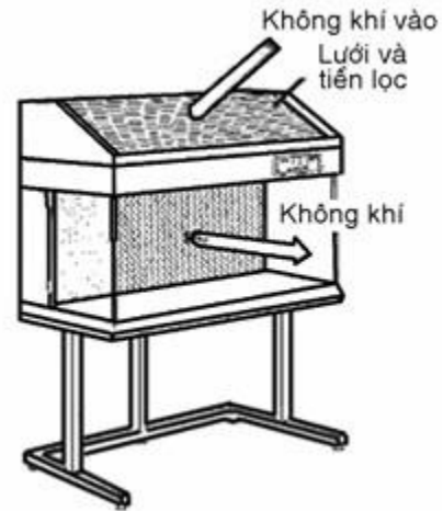
Hình 13.3. Mô hình thổi khí không theo một chiều
