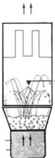
Hình 10.23. Nguyên tắc hoạt động của máy tạo hạt tầng sôi
